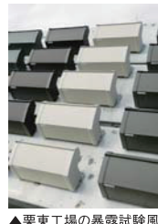
▲東東工場の暴露試験風景（南面35°傾斜）
