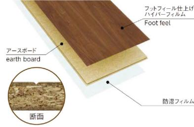
「ラシッサSフロアアース」の基材には、建築廃材を再利用してつくられた「アースボード」を使用しています。「アースボード」は、住宅・住設機器などを解体した際に発生する建築廃材をチップ化し、選別したうえで、耐水性の高い接着剤で固めた「木を循環させて使う」基材です。合板よりも硬くて強い基材を実現します。
